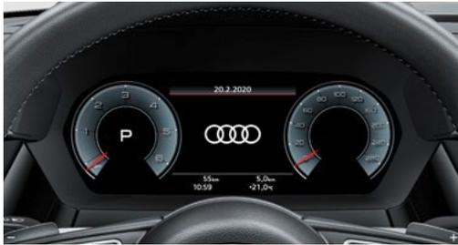
Mit dem Audi virtual cockpit plus steht ein innovatives, volldigitales Kombiinstrument zur flexiblen und bedarfsgerechten Anzeige von Informationen zur Verfügung. Das 12,3-Zoll-Display hat eine Auflösung in Full-HD-Qualität. Angezeigt werden können entsprechend den Fahrerbedürfnissen Geschwindigkeit, Drehzahl, Kartendarstellung, Audi connect-Dienste<sup>1</sup>, Radio- und Media-Informationen und vieles mehr.
