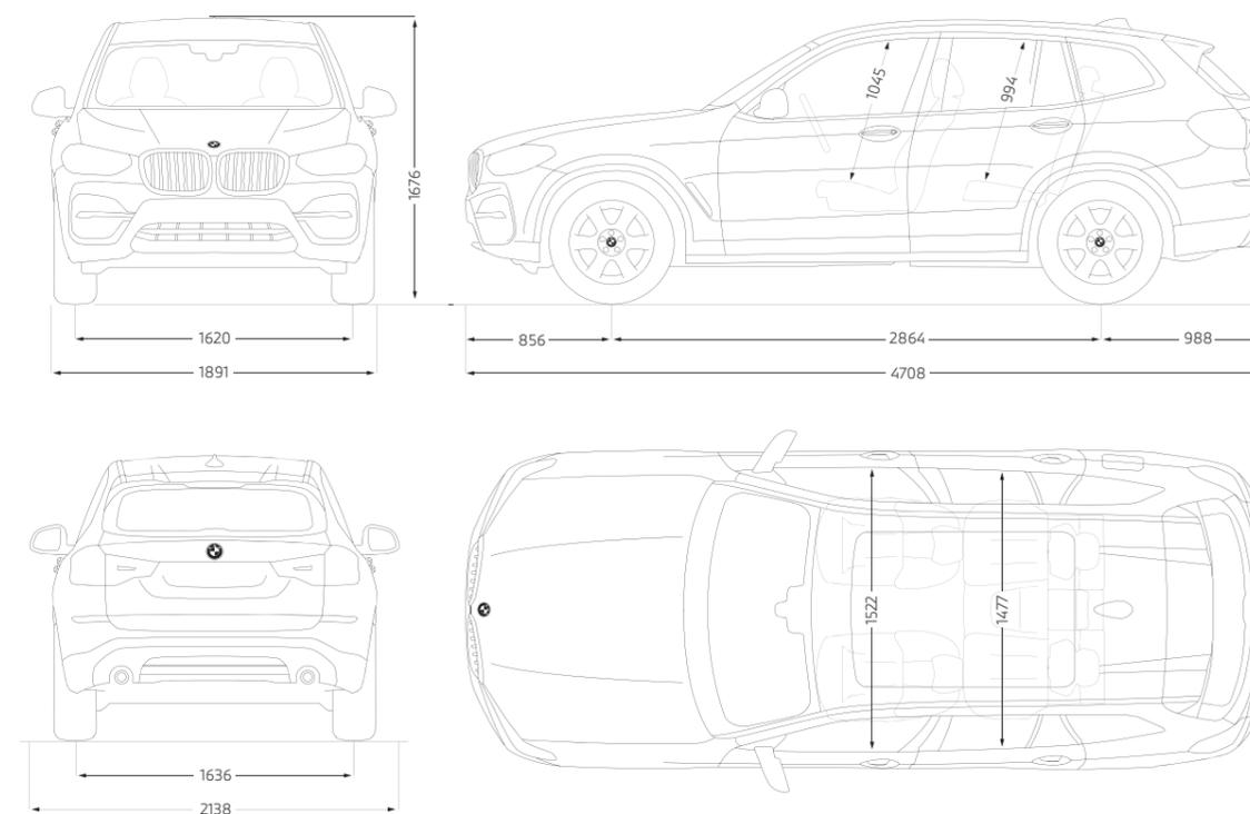
Alle Maßangaben der technischen Zeichnung in Millimeter. Angaben zu Fahrleistung, Verbrauch und CO<sub>2</sub>-Emission gelten für Fahrzeuge mit Seriengetriebe.
