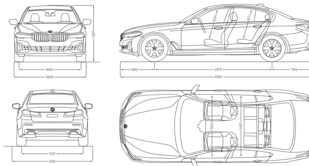
Alle Maßangaben der technischen Zeichnung in Millimeter. Höhe ohne Dachantenne beträgt 1466 mm. Angaben zu Fahrleistung, Verbrauch und CO<sub>2</sub>-Emission gelten für Fahrzeuge mit Seriengertriebe.
