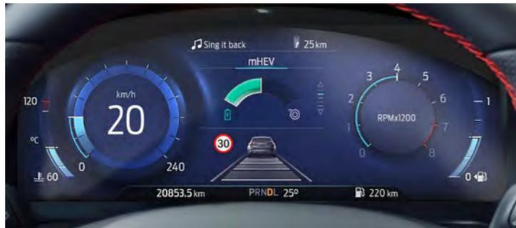
Als EcoBoost Hybrid (mHEV) verfügt das Fahrerinformationssystem zusätzlich über einen Mild-Hybrid-Informationsbereich, der anzeigt, ob die Batterie geladen oder als zusätzliche Unterstützung bei der Beschleunigung eingesetzt wird.
