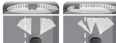
Deaktivierung einzelner LEDs, damit vorausfahrendes Fahrzeug nicht geblendet wird.
