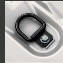
Sechs am Boden be- festigte Verzurrösen.
