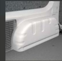
Flache Radkästen machen das Stapeln von Ladung einfacher.
