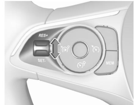
Die voreingestellte Höchstgeschwindigkeit kann durch Drücken des Daumenrädchens auf **RES/+** erhöht bzw. auf **SET/-** gesenkt werden. Daumenrädchen mehrmals kurz schieben, um die Geschwindigkeit in kleinen Schritten zu ändern, länger schieben, um sie in großen Schritten zu ändern.
