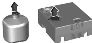
4. Typ A: Dichtmittelflasche öffnen und Deckel anheben.
