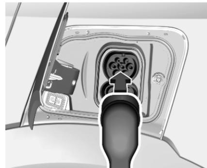
5. Den Fahrzeugstecker des Mode-3-Ladekabels am Ladeanschluss des Fahrzeugs anschließen.
