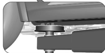
Die Position der vorderen Arme der Hebebühne befindet sich mittig unter den entsprechenden Wagenhebearaufnahmen.
