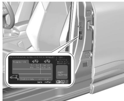
Das Reifendruckhinweisschild an der linken B-Säule gibt die Originalreifen und die entsprechenden Reifendrucke an.
