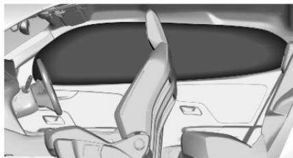
Der aufgeblähte Airbag dämpft den Aufprall, wodurch die Verletzungsgefahr für den Kopf bei einem Seitenaufprall deutlich verringert wird.
