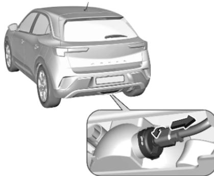
1. Die Lampenfassung linksherum drehen und aus dem Reflektorgehäuse ziehen.
