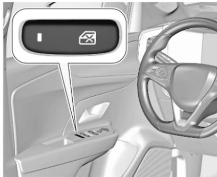
Zur Deaktivierung der elektrischen Fensterheber der hinteren Türen
