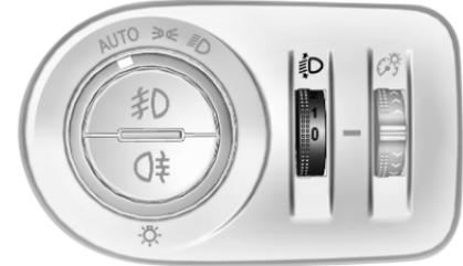
Die Leuchtweite kann manuell angepasst werden, wenn das Fahrzeug nicht mit Matrix-LED-Scheinwerfern ausgerüstet ist. Matrix-LED-Scheinwerfer werden automatisch eingestellt.
