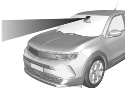
Die Spurverlassenswarnung unterstützt den Fahrer beim Vermeiden eines unbeabsichtigten Verlassens der Fahrspur. Die Frontkamera überwacht Straßenränder sowie die Spurmankierungen, zwischen denen das Fahrzeug fährt. Wenn sich das Fahrzeug dem Fahrbahnrand oder einer Fahrspurmarkierung nähert, warnt das System den Fahrer.
