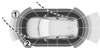
Wenn sich das Hindernis (1) in der Fahrspur des Fahrzeugs befindet und möglicherweise eine Kollision bevorsteht, ertönt ein akustisches Warnsignal.
