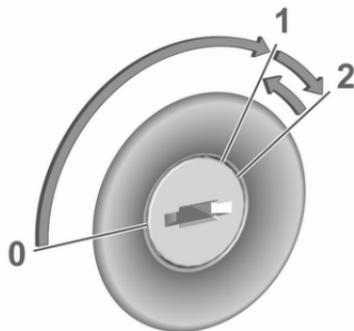
Den Schlüssel in Stellung 1 drehen, um die Lenksperre freizugeben.
