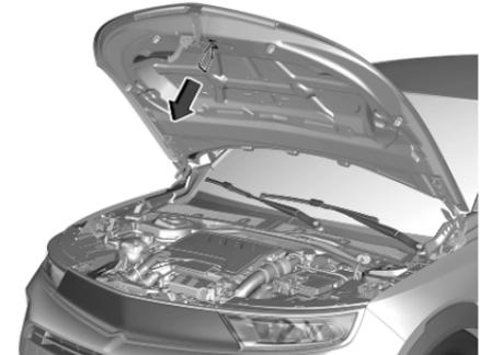
Die Motorhaube absenken und aus geringer Höhe (20–25 cm) in die Rastung fallen lassen. Sicherstellen, dass die Motorhaube eingerastet ist.
