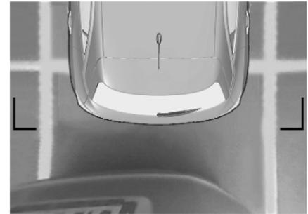
Durch Aufzeichnung der Fahrzeugumgebung während des Manövers rekonstruiert die Rückfahrkamera die Darstellung der Fahrzeugumgebung von oben. So hat der Fahrer eventuelle Hindernisse immer im Blick. Diese Ansicht ist im Automatikmodus oder im Ansichtsauswahlm Menü verfügbar.
