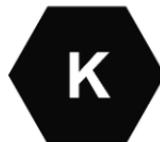
FF-Stecker bzw. -Anschluss zum Laden mit Gleichstrom
