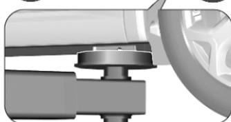
Die Position der hinteren Arme der Hebebühne befindet sich mittig unter den entsprechenden Wagenhebearaufnahmen.
