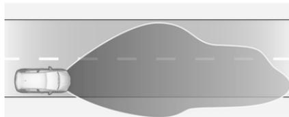
Wird beim Fahren in ländlichen Gebieten automatisch bei Geschwindigkeiten über 50 km/h aktiviert. Die Ausleuchtung der eigenen Fahrbahn und des Fahrbahnrandes wird angepasst. Entgegenkommende und vorausfahrende Fahrzeuge werden nicht geblendet.
