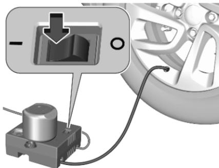
12. Wippschalter auf dem Kompressor auf I stellen. Der Reifen wird mit Dichtmittel gefüllt.
