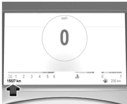
Die erfasste Gesamtfahrstrecke wird in km angezeigt.
