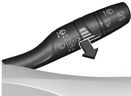
Hebel ziehen. Waschflüssigkeit spritzt auf die Windschutzscheibe und der Wischer wird für einige Wischbewegungen eingeschaltet. Waschflüssigkeit ↪ 268.
