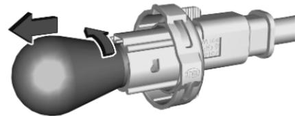
2. Lampe leicht nach unten drücken, linksherum drehen und aus der Fassung ziehen.
