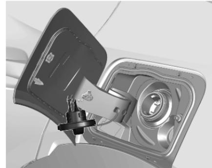
Der Deckel kann am Haken an der Tankklappe eingehängt werden.
