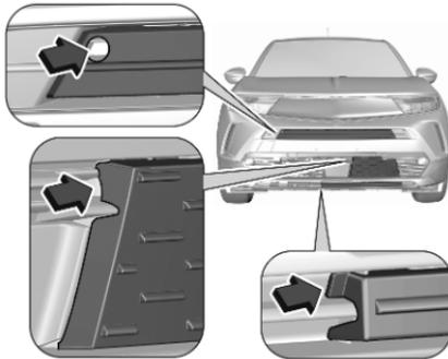
Die Kälteschutzabdeckungen entfernen. Dazu diese an den angegebenen Stellen vorsichtig herausziehen.
