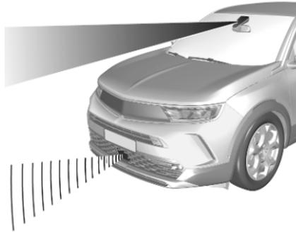
Das System erkennt vor Ihnen befindliche Fußgänger mithilfe der Frontkamera in der Windschutzscheibe und, je nach Fahrzeugkonfiguration, einer Radareinheit im vorderen Stoßfänger.
