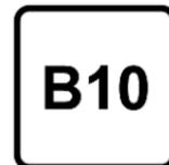
Dieselmotoren gemäß der Norm EN16734, gemischt mit einem Biokraftstoff gemäß der Norm EN14214 (mit bis zu 10 % Fettsäuremethylester).
