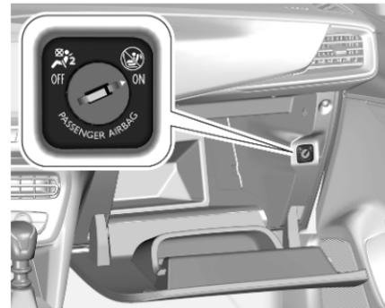
Das Airbag-System des Beifahrersitzes kann mit dem Schlüssel über einen Schalter im Handschuhfach deaktiviert werden.
