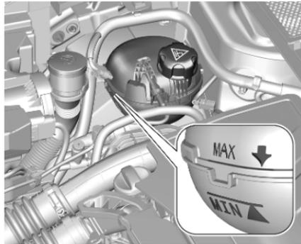
Liegt der Kühlmittelstand auf oder unter der **MIN**-Markierung, die Hilfe einer Werkstatt zum Auffüllen des Kühlmittels in Anspruch nehmen.
