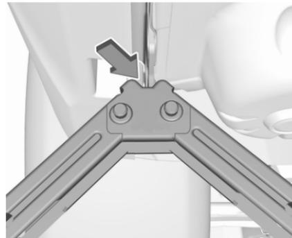
Sicherstellen, dass die Karosseriekante in der Kerbe am Wagenheber sitzt.
