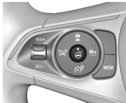
Die Heizung durch Drücken von
