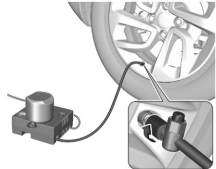
9. Den Einfüllschlauch am Reifenventil anschrauben.
