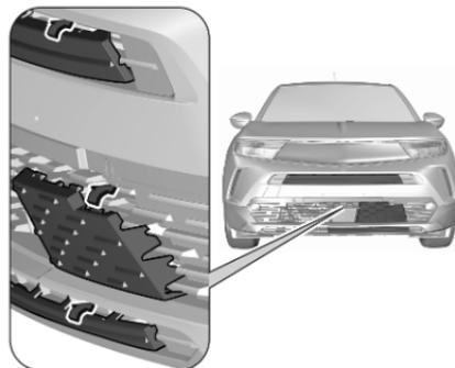
2. Von außen den oberen Teil der Kälteschutzabdeckungen gegen die Lamellen des Gitters drücken.
