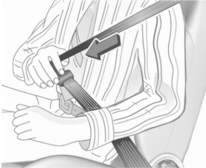
Den Sicherheitsgurt aus dem Aufroller herausziehen, unverdreht über den Körper führen und die Schlosse in das Gurtschloss einstecken, bis sie einrastet. Sicherstellen, dass der Sicherheitsgurt über die Schulter verläuft und während der Fahrt eng am Körper anliegt.
