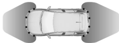
Das System arbeitet mit Ultraschall-Parkensensoren im hinteren und vorderen Stoßfänger.
