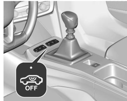
Wenn Tiere im Fahrzeug zurückgelassen werden, muss die Überwachung des Fahrzeuginnenraums und der Fahrzeugneigung abgeschaltet werden, weil laute Ultraschallsignale
