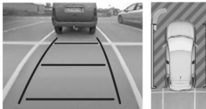
Der Bildschirm im Info-Display ist zweigeteilt. Rechts erscheint ein Bild des Fahrzeugs von oben, links die Ansicht von hinten. Bei Fahrzeugen, die mit Ultraschall-Einparkensoren ausgestattet sind, ergänzen diese die Informationen zur Ansicht des Fahrzeugs von oben.
