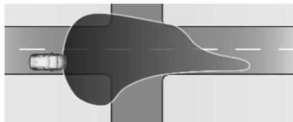
Wird automatisch bei Geschwindigkeiten bis ca. 50 km/h aktiviert. Der Lichtstrahl ist breit und symmetrisch.
