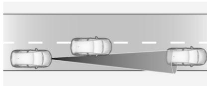
Wechselt ein anderes Fahrzeug auf die von Ihnen verwendete Spur, berücksichtigt der adaptive Geschwindigkeitsregler das Fahrzeug erst nach dem vollständigen Spurwechsel. Darauf gefasst sein, bei Bedarf das Bremspedal zu betätigen.
