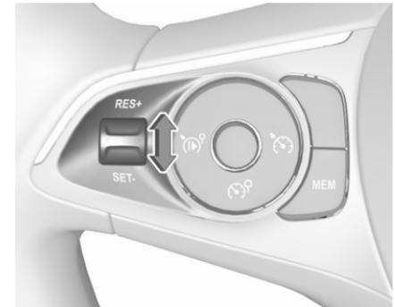
Bis zur gewünschten Geschwindigkeit beschleunigen und das Daumenrädchen kurz auf **SET/-** drehen. Die aktuelle Geschwindigkeit wird gespeichert und beibehalten. Gaspedal kann gelöst werden.
