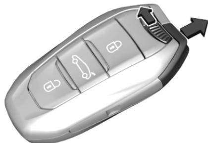
Elektronischer Schlüssel: Die Arretierung drücken, um den integrierten Schlüssel auszuklappen.
