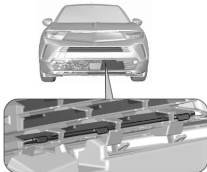
1. Den unteren Teil der jeweiligen Kälteschutzabdeckung wie abgebildet auf die Innenseite des Gitters setzen.
