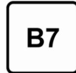
Dieselmotorkraftstoff gemäß der Norm EN590, gemischt mit einem Biokraftstoff gemäß der Norm EN14214 (mit bis zu 7 % Fettsäuremethylester).
