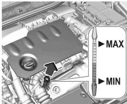
Messtab herausziehen, abwischen, vollständig einführen, erneut herausziehen und den Motorölstand ablesen.
