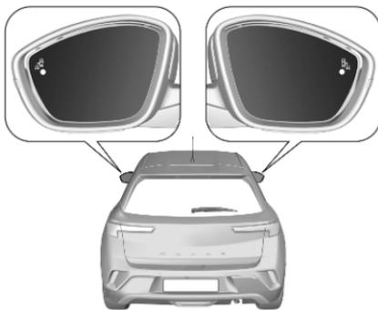
Erkennt das System bei Vorwärtsfahrt ein Fahrzeug im toten Winkel, leuchtet im entsprechenden Seitenspiegel eine LED auf. Wenn die Blinker auf der entsprechenden Seite aktiviert sind, blinkt die LED.
