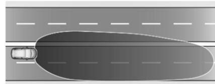
Wird bei einer Geschwindigkeit über 105 km/h automatisch aktiviert. Die Leuchtweite wird an die höhere Autobahngeschwindigkeit angepasst. Ohne Gegenverkehr wird die Sicht auf der Fahrzeugseite erhöht. Bei vorausfahrenden Fahrzeugen bzw. beim Überholen wird der andere Verkehrsteilnehmer weniger geblendet.
