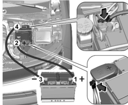
Reihenfolge für das Anschließen der Kabel:
