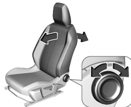
Handrad drehen. Zum Einstellen Rückenlehne entlasten.
