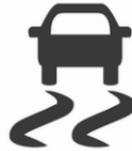
Die elektronische Stabilitätsregelung und die Traktionskontrolle sind nach jedem Motorstart funktionsfähig, sobald die Kontrollleuchte
