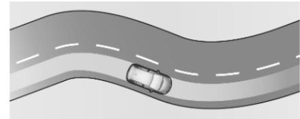
Auf diese Weise hält das System das Fahrzeug in der aktuellen Fahrspur.
