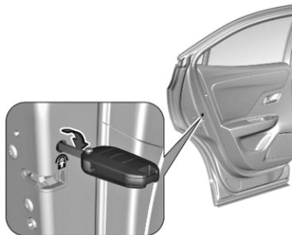
Rote Kindersicherung in der hinteren Tür mit einem Schlüssel in Richtung Fahrzeuginnenraum in die waagerechte Stellung drehen. Die Tür lässt sich dann von innen nicht öffnen.
