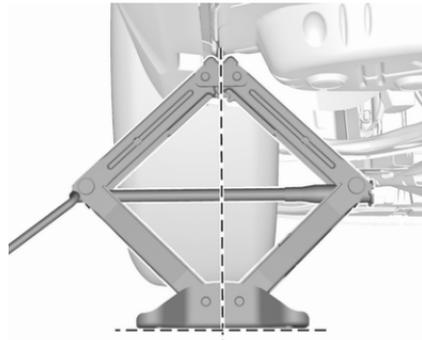
4. Wagenheber auf die erforderliche Höhe einstellen. Direkt unter dem Aufnahmepunkt so positionieren, dass er nicht abrutschen kann.
