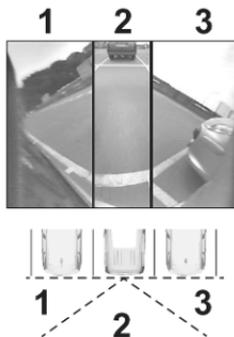
Die 180°-Ansicht erleichtert das Rückwärtsausparken, indem sie sich annähernde Fahrzeuge, Fußgänger und Radfahrer sichtbar macht. Für komplette Manöver wird diese Ansicht nicht empfohlen. Sie besteht aus drei Anzeigebereichen: links 1, Mitte 2 und rechts 3. Diese Ansicht kann nur über das Auswahlm Menü aufgerufen werden.
