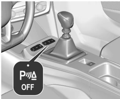
Zur manuellen Deaktivierung des Systems auf  $P_{\Delta}^{OFF}$  drücken oder die elektrische Parkbremse betätigen. Wird das System manuell deaktiviert, leuchtet die LED in der Taste auf. Nach dem manuellen Ausschalten wird das System beim nächsten Einschalten der Zündung nicht automatisch wieder aktiviert.
