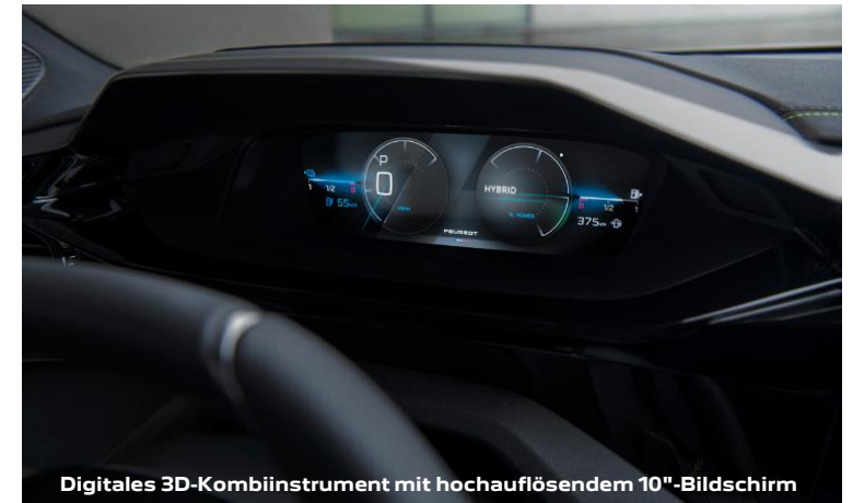
Digitales 3D-Kombiinstrument mit hochauflösendem 10"-Bildschirm
