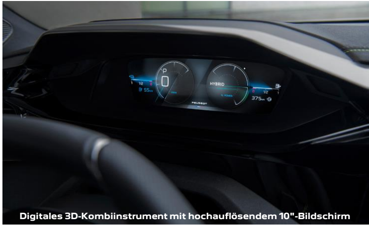
Digitales 3D-Kombiinstrument mit hochauflösendem 10"-Bildschirm
