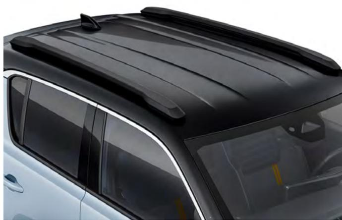
Standarddach und Dachreling längs in schwarzem Aluminium
