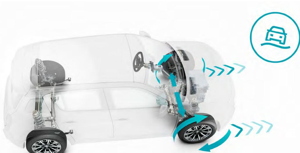
die weiterentwickelte Antriebsschlupfregelung Extended Grip
