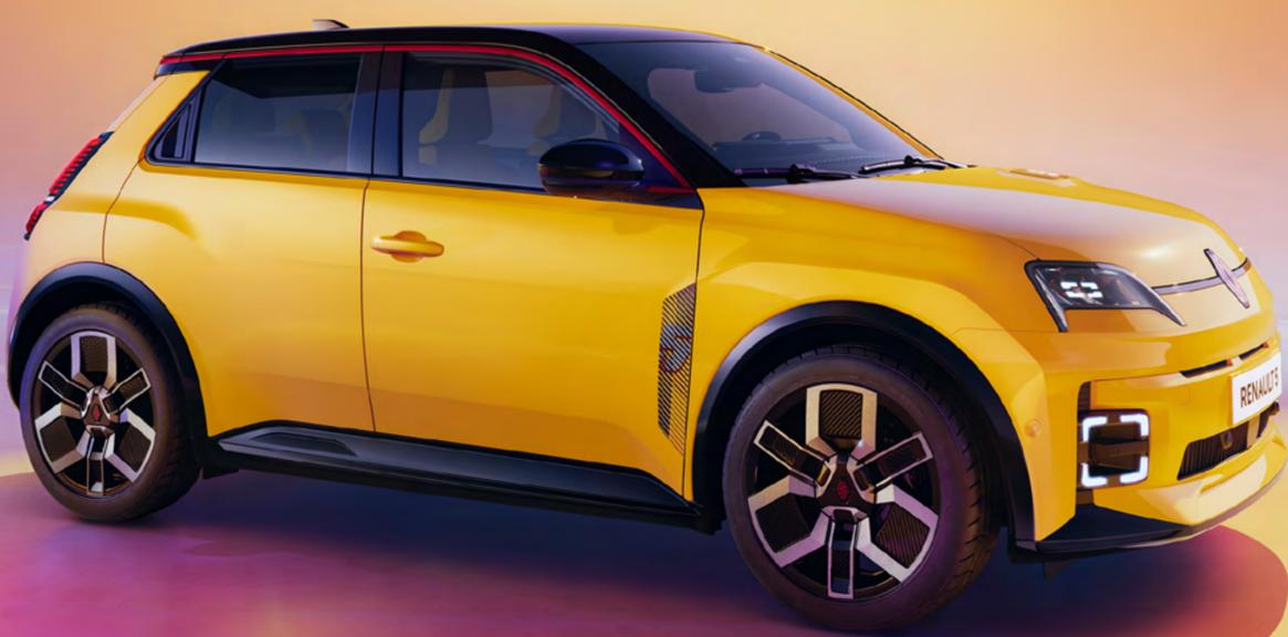
Sein Elektroantrieb leistet 110 kW/ 150 PS, und sein bidirektionales Ladegerät eröffnet ganz neue Möglichkeiten der Elektromobilität.
