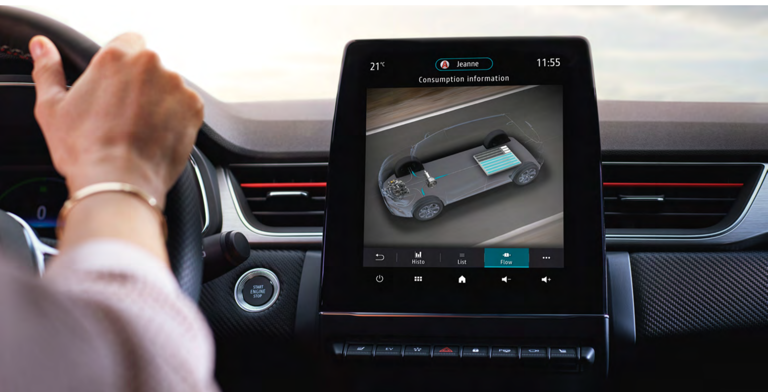
Zentrales 9,3-Zoll-Display mit Darstellung des aktuellen Energieflusses
