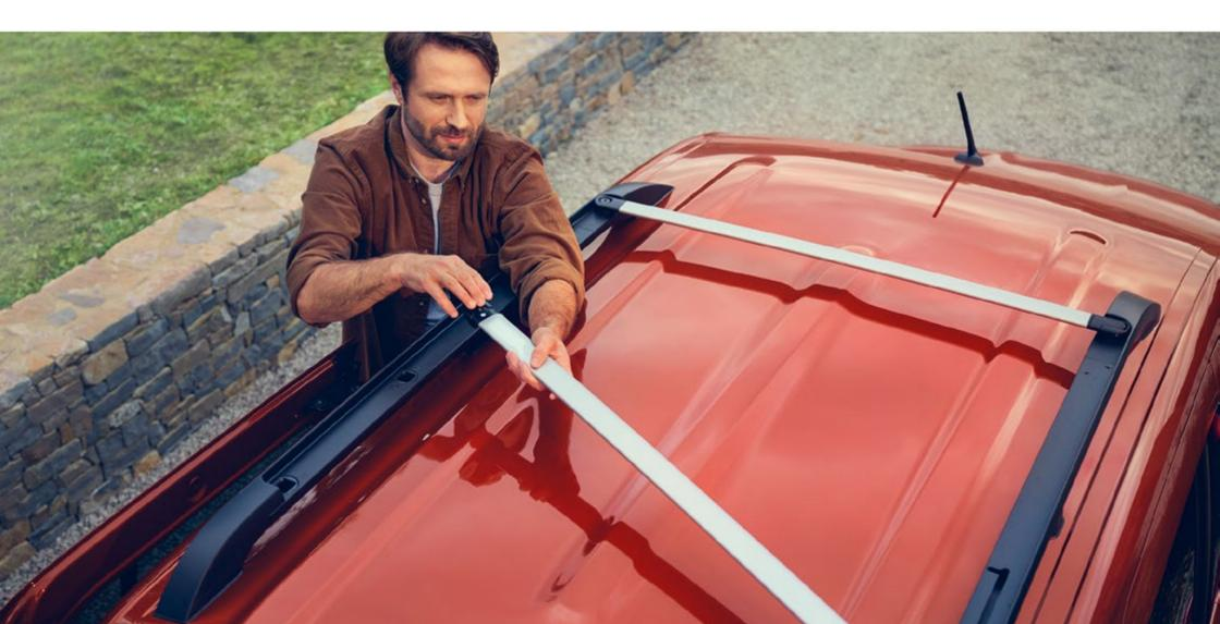
werkzeuglos montierbarer Dachträger
