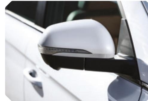
In die Außenspiegel sind die Seitenblinker und die praktische Umfeldbeleuchtung integriert.
