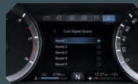
Auswahl unterschiedlicher Blinkersignale
