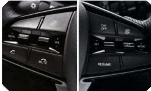
Bedienelemente für Radio, Geschwindigkeitsregelanlage und Lenkradheizung
