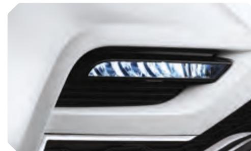
LED-Nebelleuchten mit integriertem Abbiegelicht
