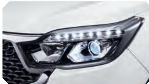
Projektionsscheinwerfer mit integriertem LED-Tagfahrlicht
