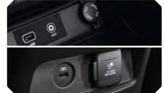
USB- und AUX-Anschluss vorne, USB- und 220-Volt-Anschluss hinten
