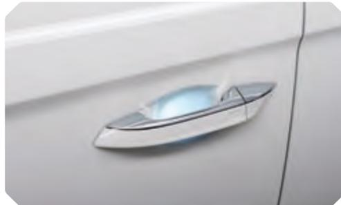
Türgriffe beleuchtet, bei Smart-Key: Entriegelung bei Berührung
