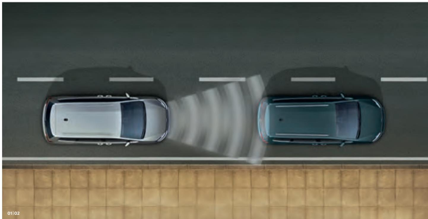
**01** Die **automatische Distanzregelung ACC** kann Ihnen helfen, eine zuvor von Ihnen gewählte Höchstgeschwindigkeit<sup>1)</sup> sowie den ebenfalls von Ihnen eingestellten Abstand zum vorausfahrenden Fahrzeug einzuhalten.<sup>2)</sup> **S**
