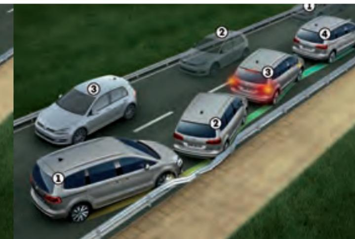
**03** Die **Multikollisionsbremse** kann nach einem Unfall automatisch bremsen, um so im Idealfall eine Folgekollision zu vermeiden.<sup>2)</sup> **S**
