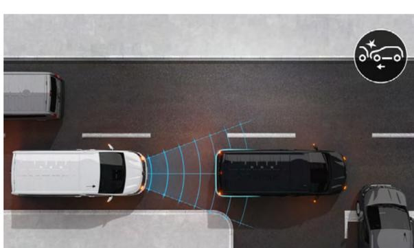
Der **Notbremsassistent** hilft Ihnen, Zusammenstöße zu vermeiden. Sobald der Sensor die Gefahr einer Kollision erkennt und Sie nicht oder nicht ausreichend reagieren, greift das Assistenzsystem ein und bremst das Fahrzeug ab.
