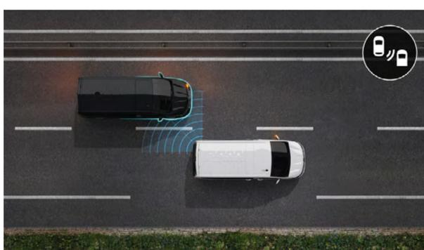
Der **Toter-Winkel-Warner** ist bei einer Geschwindigkeit zwischen 30 km/h und 140 km/h aktiv und warnt Sie mit einem Lichtsignal, wenn sich ein Fahrzeug hinter Ihnen befindet, das im Rückspiegel nicht zu sehen ist.
