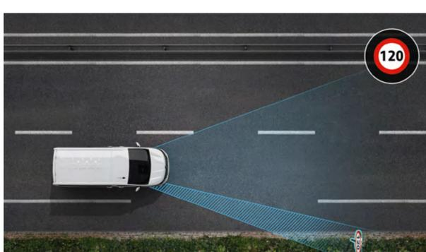
Die **Verkehrszeichenerkennung mit Geschwindigkeitswarner** zeigt Ihnen im Instrumententräger die aktuell zulässige Geschwindigkeit an und warnt Sie, wenn Sie die Höchstgeschwindigkeit überschreiten. Dazu dient eine Kamera oben in der Windschutzscheibe.
