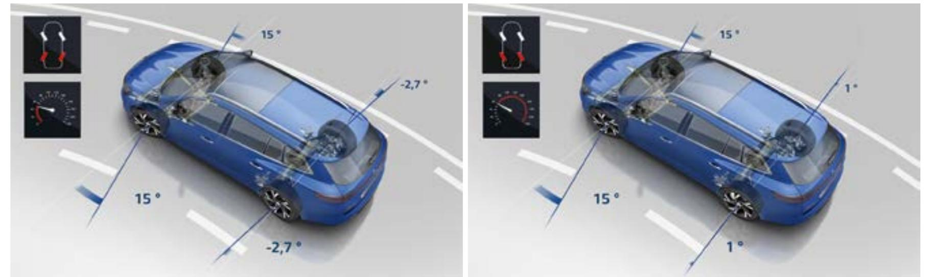
Bei niedriger Geschwindigkeit schlagen die Hinterräder in die entgegengesetzte Richtung der Vorderräder ein: Mehr Wendigkeit, höhere Agilität.
